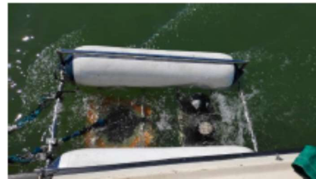
Figura 44 Streamer y GPS empleados en el levantamiento sísmico. Catamarán con Geopulse y perfilador.
